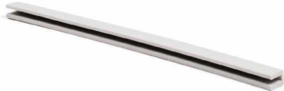
Junquillo para apoyo del cristal 6mm. Se utiliza en el perfil 20 con pestaña para estante.
